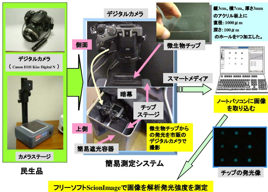
図 1 発光細菌チップを用いたオンサイト簡易環境測定システム
